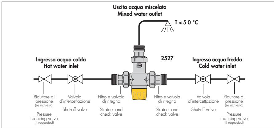
**Schema applicativo - Application Diagrams - Einbaubeispiel - Schémas d'application - Esquema aplicativo - Esquema de aplicação - Toepassingsschema**
