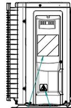
In caso di rimozione della copertura della valvola di arresto.
